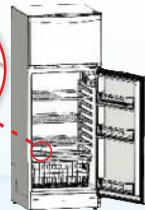
En las unidades equipadas con dispenser, puede desmontar todos los elementos para su limpieza. Recuerde no utilizar limpiadores con aromas. La canilla se podrá desmontar si la gira cuidadosamente 1/4 de vuelta en sentido antihorario. Teniendo la precaución que al instalarla nuevamente hacerla girar 1/4 de vuelta en sentido horario para que quede trabada evitando goteos o filtraciones.
