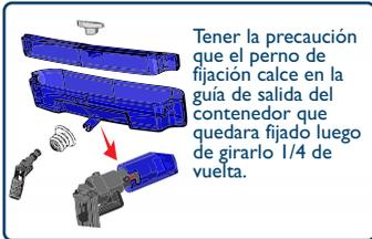
Tener la precaución que el perno de fijación calce en la guía de salida del contenedor que quedara fijado luego de girarlo 1/4 de vuelta.
