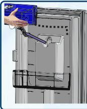
Para desmontarlo, levante el conjunto sujetándolo desde el contenedor hasta que se destrabe, luego tirar suavemente hacia afuera. Para montarlo siga los pasos inversamente, teniendo la precaución que el accionador apunte hacia el orificio de entrada.
